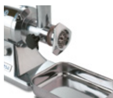
W standardzie misa odbierająca ze stali nierdzewnej
